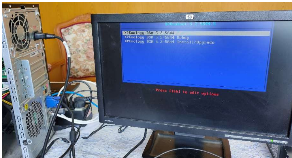
(ภาพแสดงการติดตั้ง DSM บนเครื่องที่เตรียมไว้สำหรับทำระบบเก็บข้อมูลกลาง)
