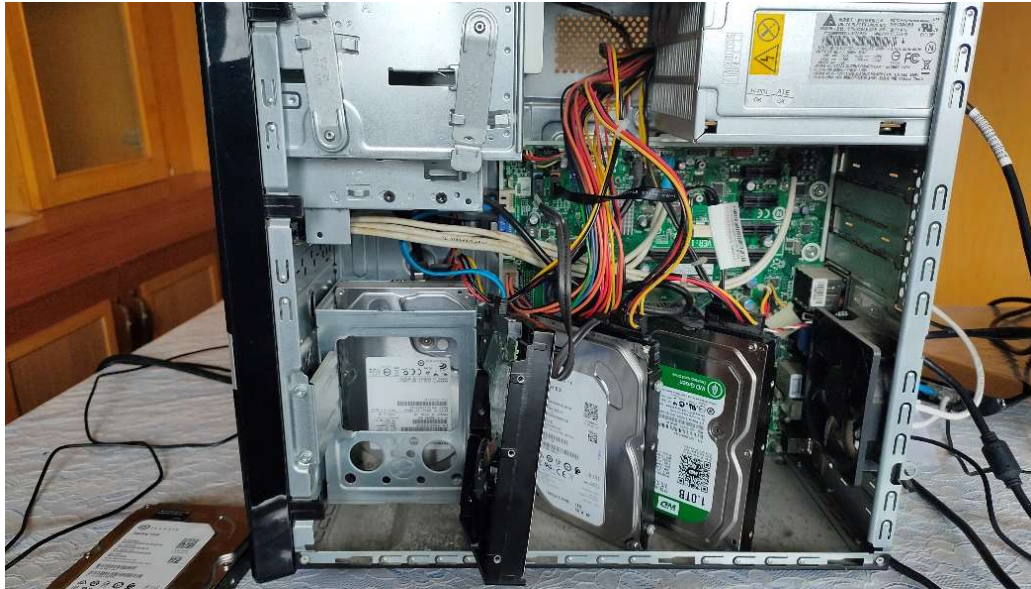
(ภาพการเชื่อมต่ออุปกรณ์เก็บข้อมูลกับแผงวงจรหลัก)
