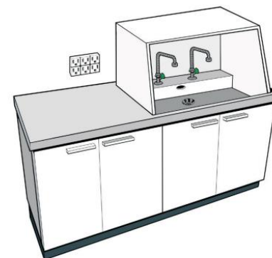
เครื่องมือและปลั๊กไฟที่อยู่ใกล้อ่างล้างมือ ควรมีฉากกัน
